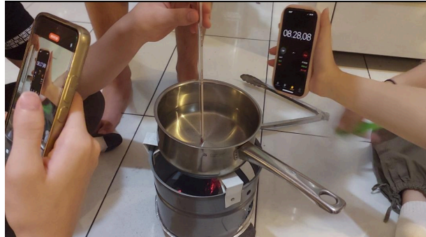
Proses uji laju pembakaran briket
