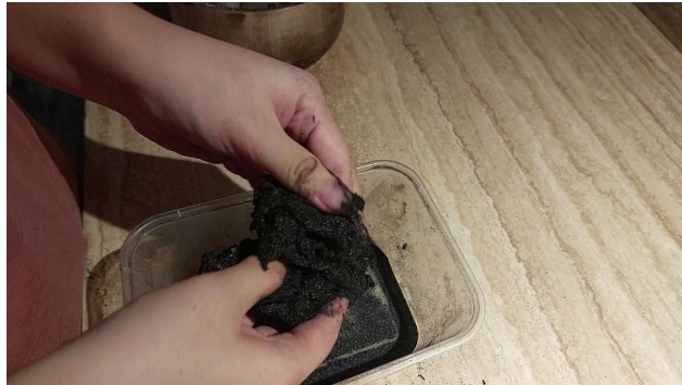
Proses pencampuran arang dengan perekat
